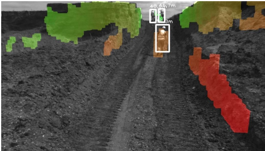
3D-Terrain Mapping von ITK Engineering erkennt Personen- und Objekte auf unwegsamem Gelände und warnt den Fahrer vor möglichen Gefahren. © ITK Engineering
