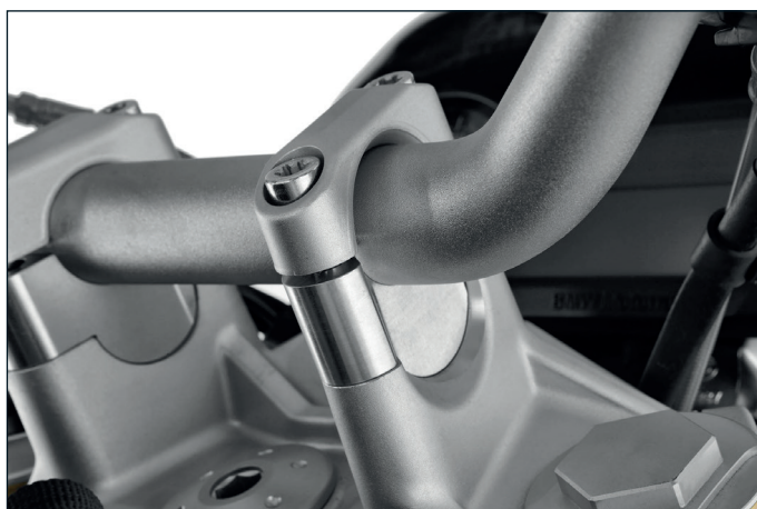
Wunderlich Lenkererhöhung +25 mm für Modelle mit und ohne Navi - Artikelnummern 31000-111 | -211
