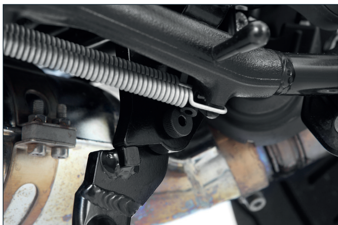
Das Doppel-Federpaket sorgt für eine sichere Arretierung des Hauptständers
