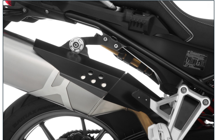
Schtzt vor Brandverletzungen und verhindert Beschdigungen am Gepck durch thermische Einflsse (Art.-Nr.: 26920-102)
