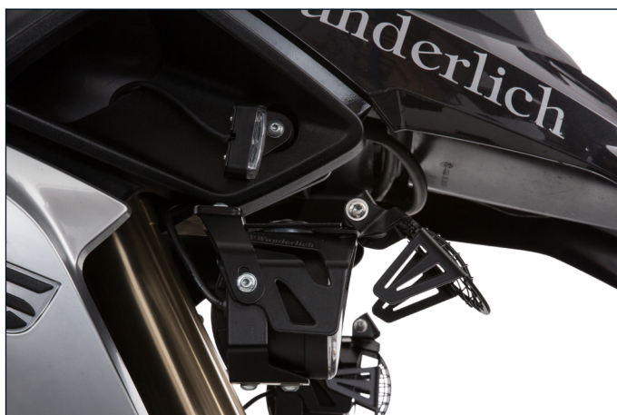
Zu reinigen ist der Scheinwerfer und das Gitter mit Leichtigkeit dank einer praktischen Klappfunktion
