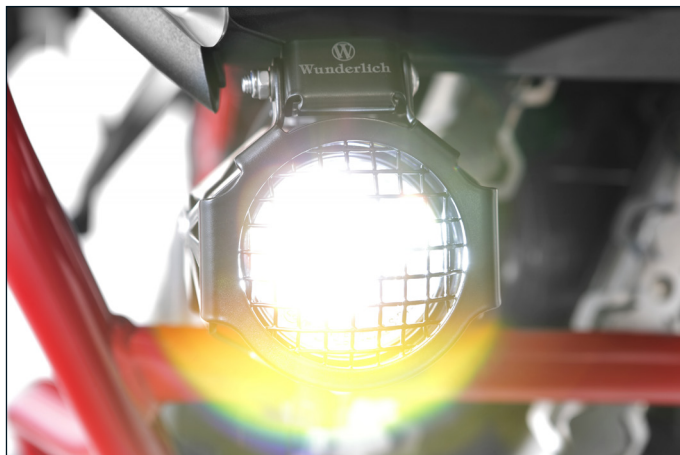
... optional mit Lampenschutzgitter zum Schutz vor aufgewirbelten Steinen (Artikel-Nr.: 42839-102)
