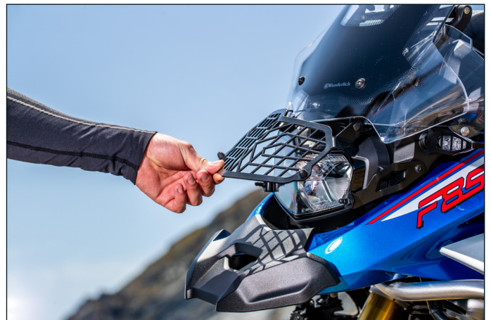
Schutzgittervariante aus hochwertigem Edelstahl, pulverbeschichtet; hochgeklappt im Straßenverkehr zugelassen
