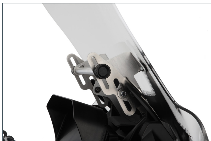
56 mm stufenlose Höheneinstellung aus der Grundeinstellung, um 11° in der Neigung einstellbar (Art.-Nr.: 25370-400)
