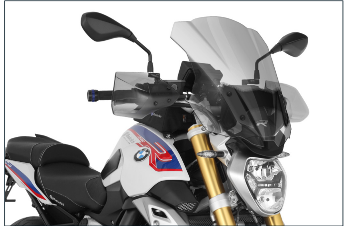
5 mm starker PMMA Acryl-Kunststoff, handpoliert, kein extra Kantenschutz nötig
