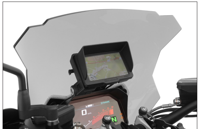
Sicht- und bedienergonomisch optimal in der natürlichen Blickrichtung, hier an einer R 1250 R (Art.-Nr.: 21096-002)
