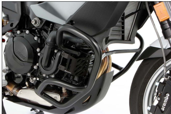
Der Wunderlich Motorschutzbügel »EXTREME« für die BMW F 900 R und XR
