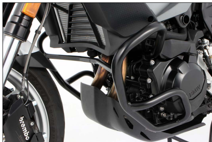
Bei einem Sturz oder Umfaller auftretende Kräfte werden damit auf je sechs Punkte pro Fahrzeugseite verteilt
