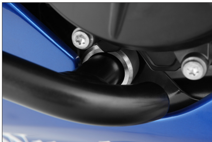
Ein spezielles Silentlager als Schwingungsdämpfer vermeidet unerwünschte Übertragung von Vibrationen und Schwingungen, besonders von unerwünschten Koppelschwingungen
