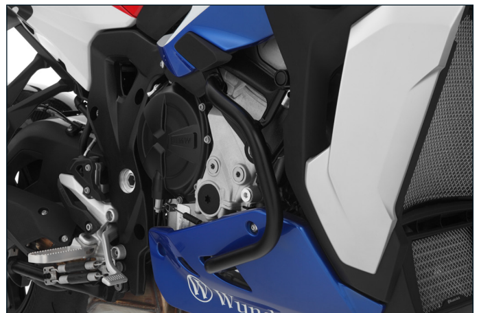
Gefertigt aus sorgfältig gebogenem, sauber verschweißtem Präzisionsstahlrohr
