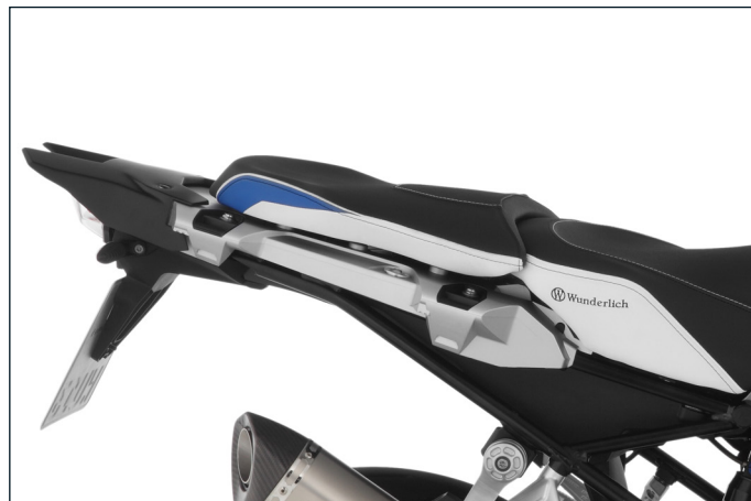
Wunderlich fertigt die Beifahrersitzbank aufgrund der um 40 mm reduzierten Höhe mit einer spezifisch angepassten 3D-Sitzkontur
