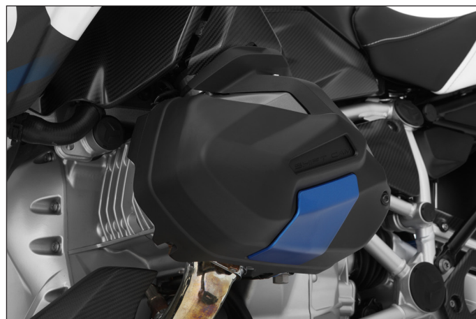
In EDITION 35-Blau lackierte, passgenaue Edelstahlintarsie - Schutzelement gegen das Durchschleifen des Ventildeckels im Falle eines Sturzes
