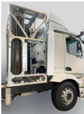
Bild 1: Das eingebaute Wasserstoff-Tanksystem auf dem Hylix-B-Prototypen (Bildnachweis: Hylix-B)
