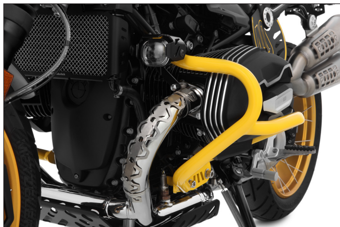
Der Motorschutzbügel schützt zuverlässig die Zylinder, die Lambdasonden und die Ventildeckel
