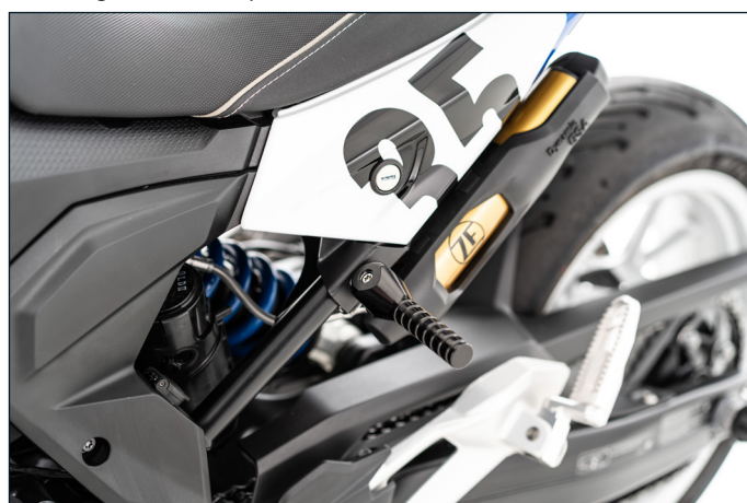
Der sehr hochwertig aus Aluminium gefertigte, funktionale Aufbockgriff, integriert sich dezent in die Linie der F 900 R und XR
