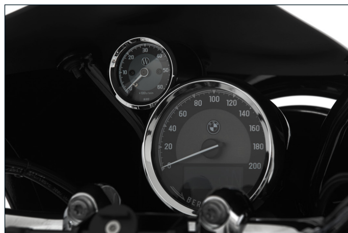
Dasselbe gilt für die hochwertig verchromte Glaseinfassung des schwarzen Drehzahlmessergehäuses sowie die LED-Beleuchtung
