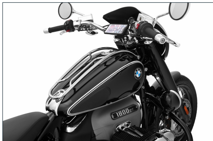
Die Tankreling ist zum Transportieren passender Taschen oder sonstigen Gepäcks ausgelegt (bis 5 kg Gewicht)
