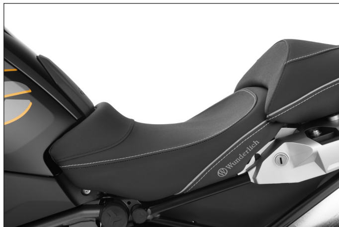
Besitzt neben der Komfort-Sitzheizung Smart Plug & Play alle Produkteigenschaften der bewährten Wunderlich AKTIVKOMFORT Sitzbänke: 3-D-Kontur, ergonomische Steißbeinentlastung, progressiver Zweischichtaufbau, ThermoPro Beschichtung
