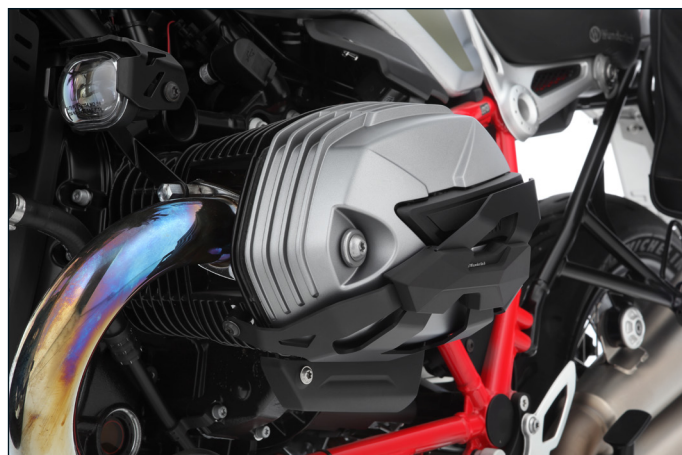
Sicher ist sicher: Gut sichtbar, das 16 mm starke Schleifpad
